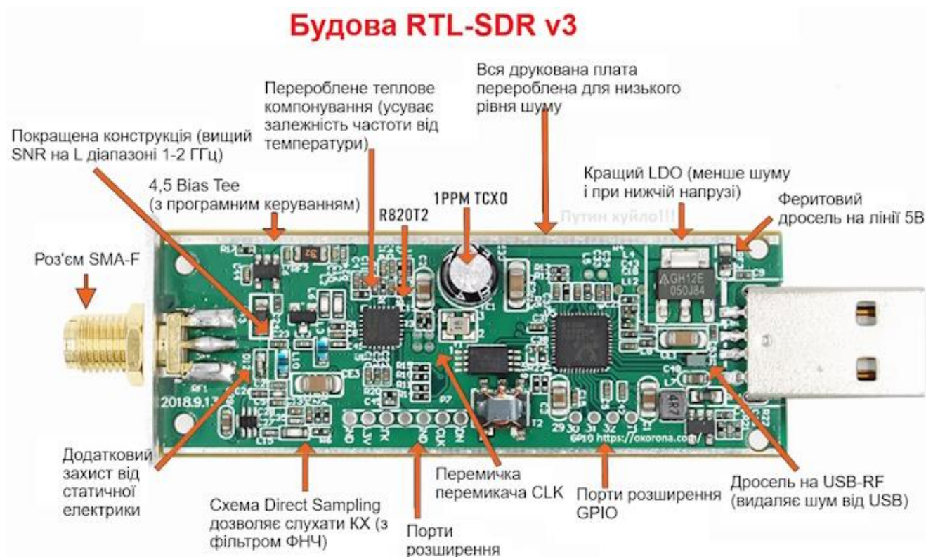
Рис. 1.1 – Один з прикладів будови SDR-радіоприймача
