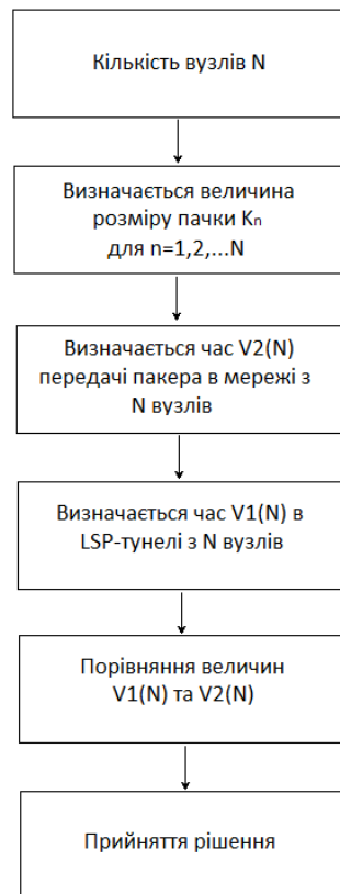
Рисунок 3.6 – Схема алгоритму організації тунелю
