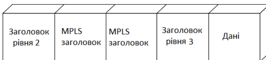
Рисунок 1.3 – Приклад дворівневого стека міток MPLS.
