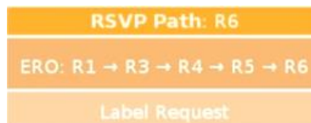
Рисунок 1.5 – Графічне зображення повідомлення RSVP-TE Path
