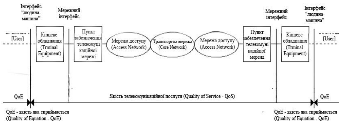
Рис. 1.2 Точки вимірювання параметрів якості телекомунікаційної послуги і характеристик мережі
