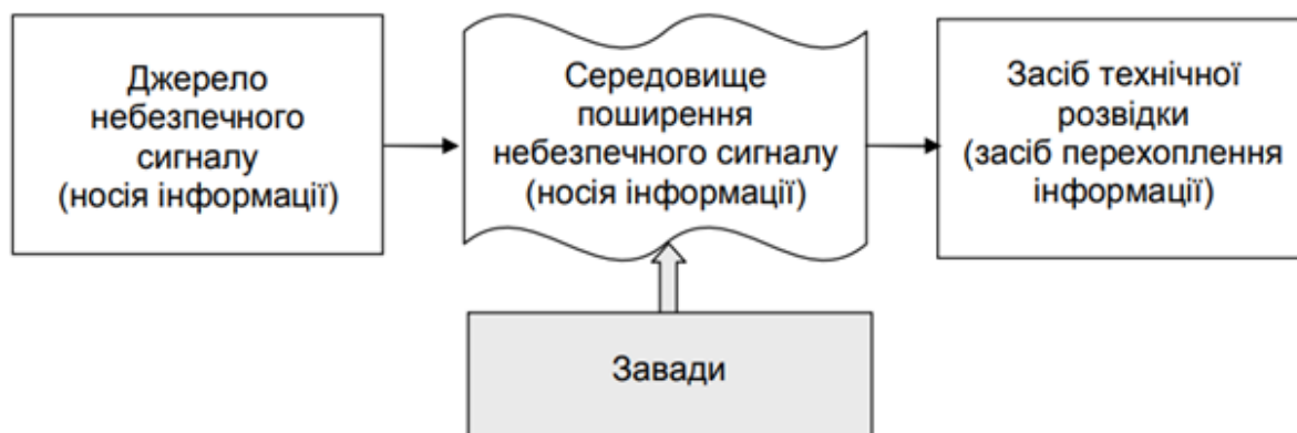
Рис. 1.2 Функціональна схема каналів технічного витоку інформації
