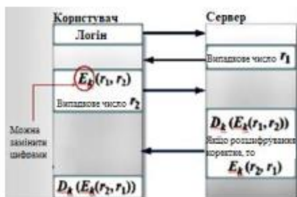
Рис. 2.11. Зустрічна автентифікація з використанням випадкових чисел
