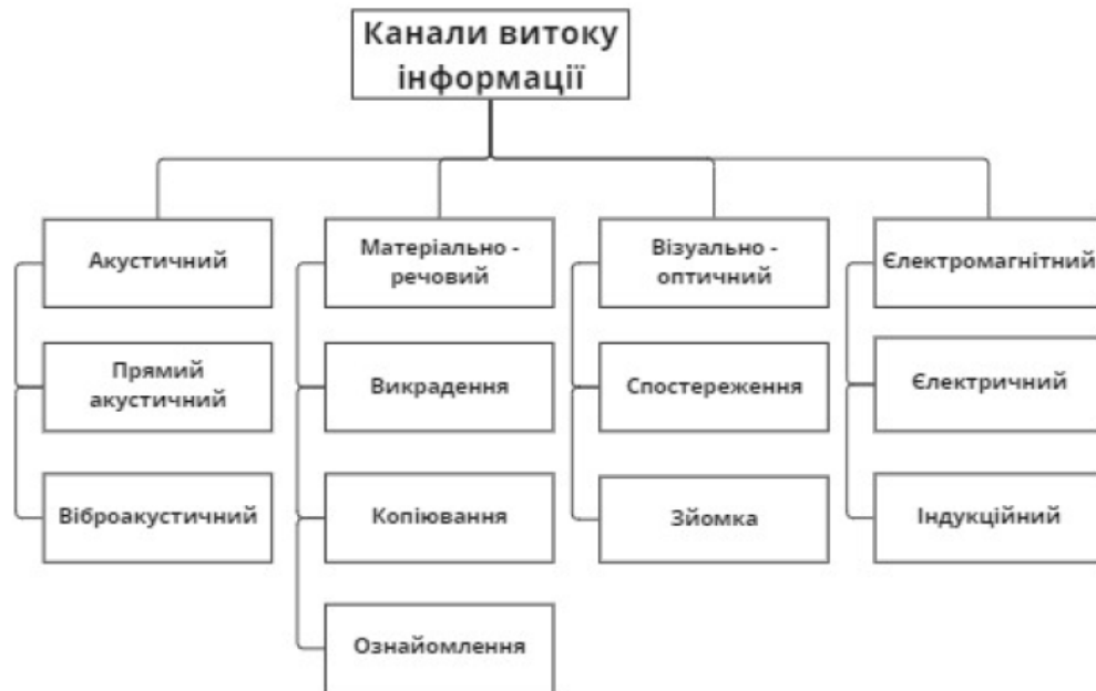
Рис. 1.2 Основні канали витоку інформації під час її обробки на ПК
