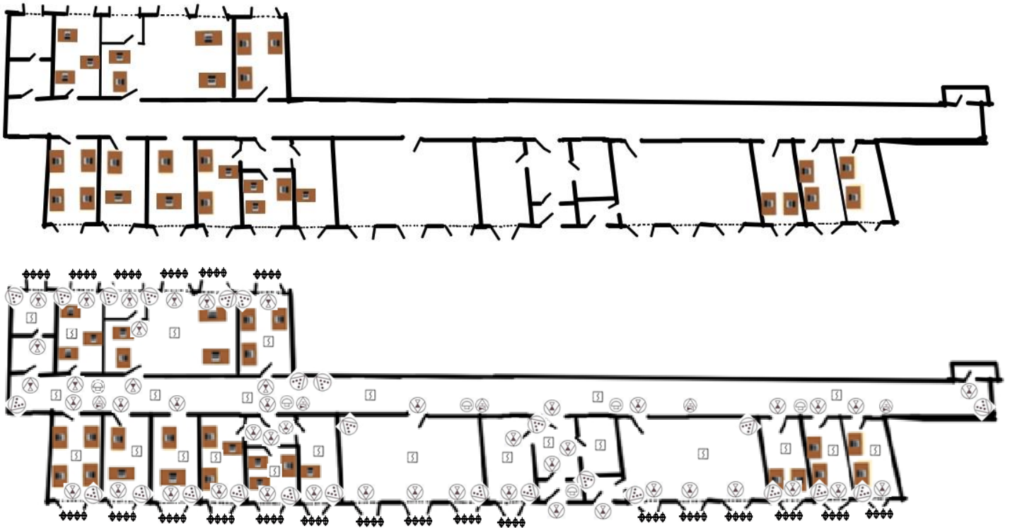
Рисунок 2.6 (а, б) – Схема плану території підприємства (а), схема технічної системи охорони (б)
