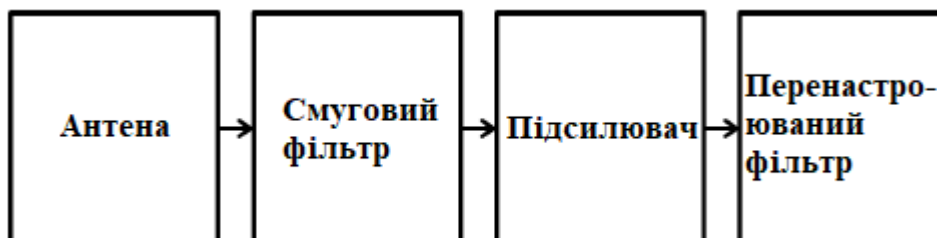
Рисунок 2.8 – Подача сигналу на адаптивний фільтр
