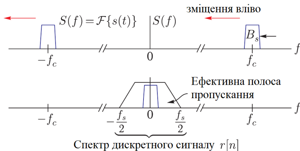
Рисунок 1.13 – Перенесення сигналу на «нульову» частоту
