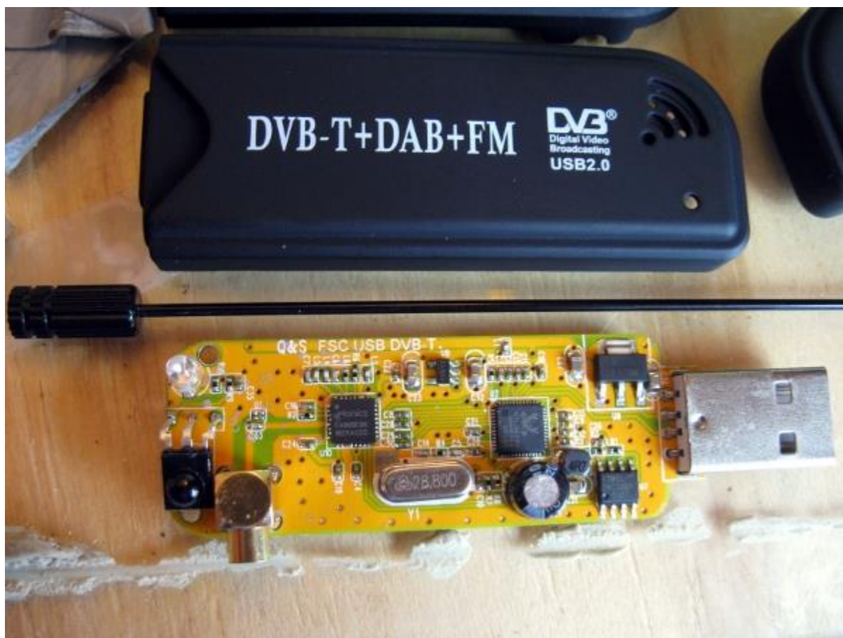
Рисунок 2.6 – Загальний вид і печатна плата SDR-приймача без модифікацій
