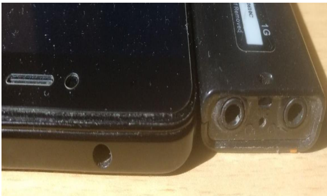
Рисунок 1.2 – Вхід 3.5 мм TRS (mini-jack) у смартфона (ліворуч) і у MP3-плеєра (праворуч)
