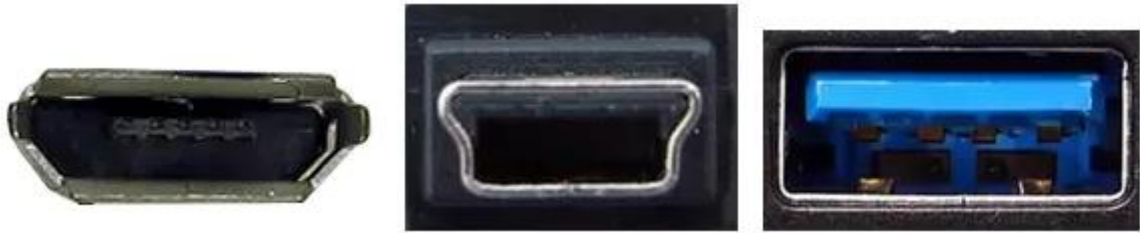
Рисунок 1.3 – Різні входи USB роз'ємів: зліва направо: micro USB; mini USB; USB
