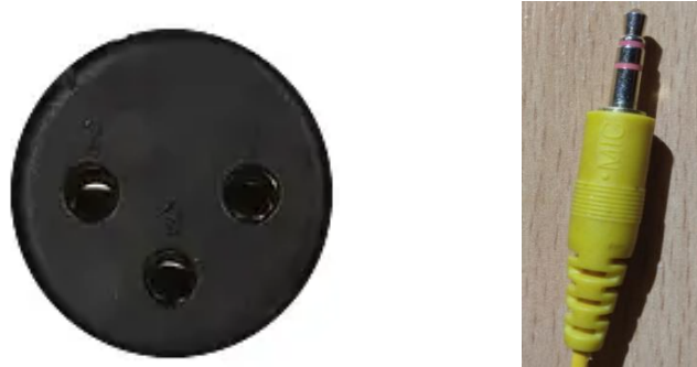
Рисунок 1.5 – Ліворуч: XLR гніздо для підключення зовнішнього мікрофона; праворуч: 3.5 мм TRS мікрофонний mini-jack
