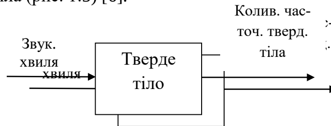
Рис. 1.5 Фізичне явище перетворення акустичних коливань у коливання твердого тіла (вібраційні коливання)
