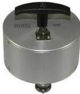
Рис. 2.13 Чутливий елемент електродинамічного типу
