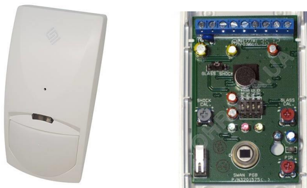
Рис. 2.11 Комбінований сповіщувач руху та розбиття скла
