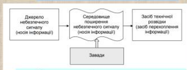
Структура технічного каналу витоку інформації
