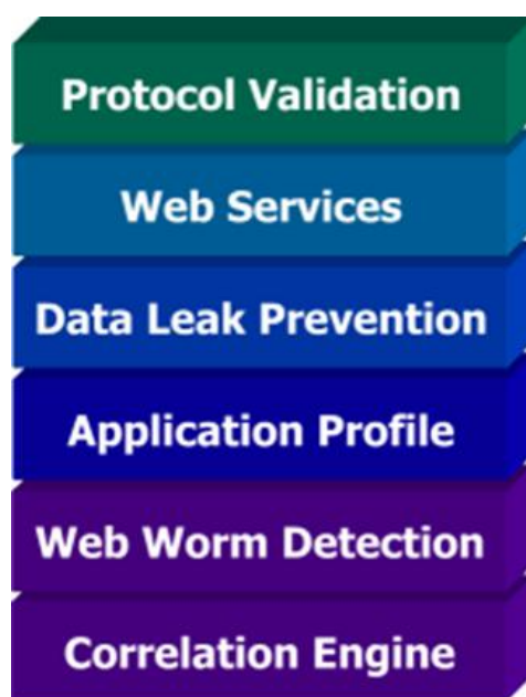
Рис. 2.3. Модель захисту, яка реалізується SecureSphere WAF [5]
