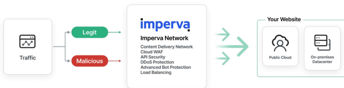
Рис. 2.8. Cloud WAF перевіряє кожен запит, фільтруючи зловмисну активність
