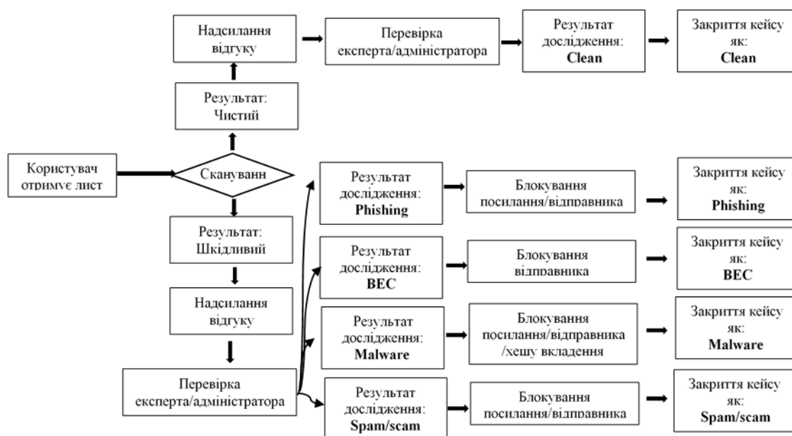
Рис.3.15. Технологія процесу розслідування інцидентів експертом з безпеки
