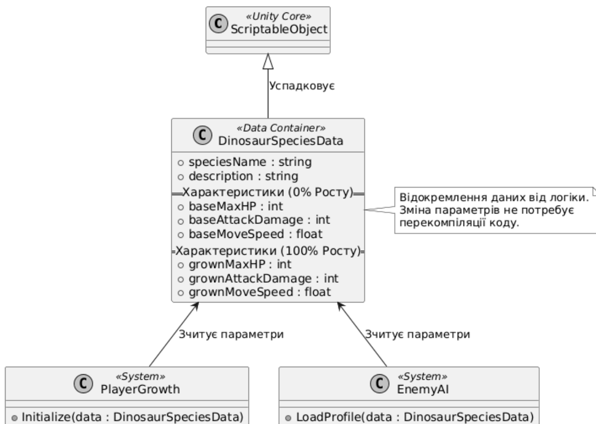
Рис. 3.4 UML-діаграма структури конфігураційних даних та їх залежностей
