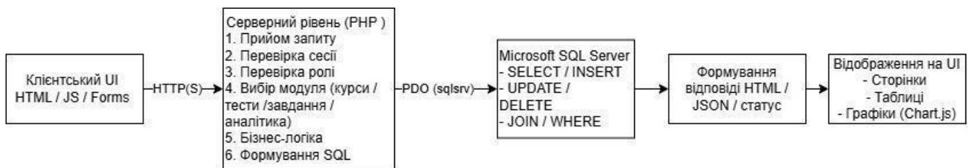
Рис. 3.8 Загальна схема обробку запиту на сервері
