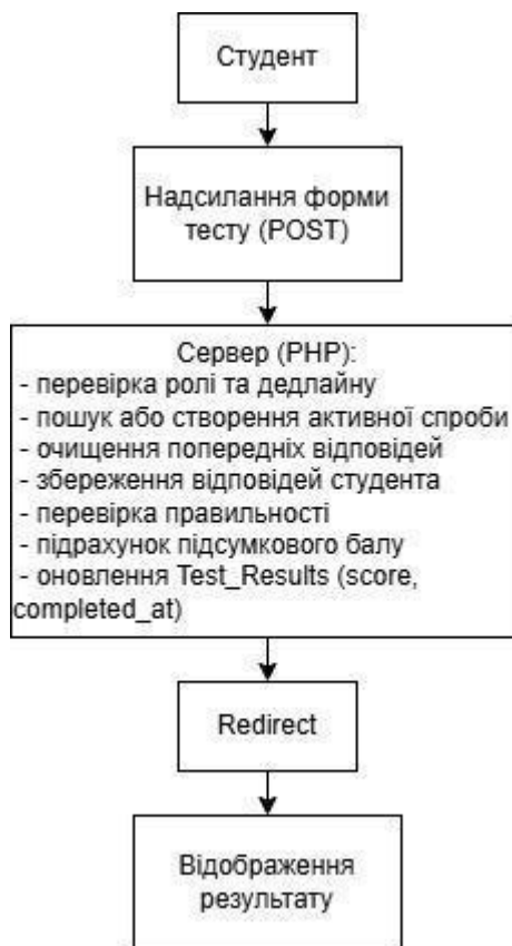
Рис. 3.11 Схема обробки відповідей під час проходження тесту
