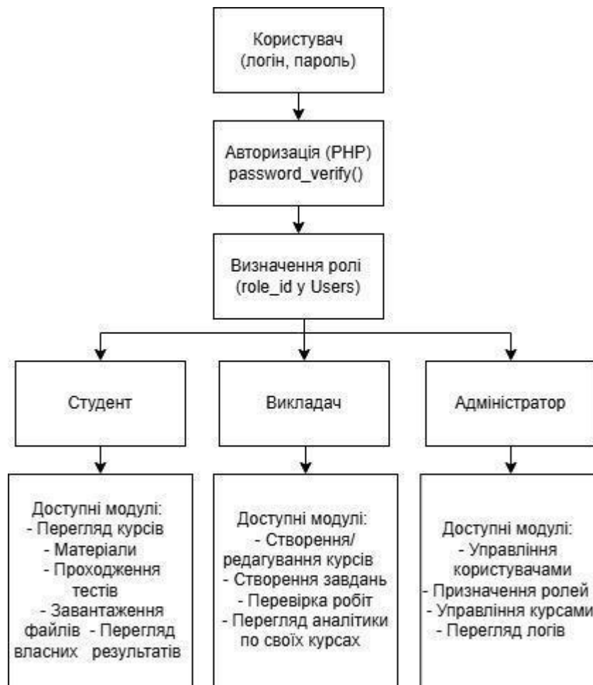
Рис. 2.4 Схема розмежування доступу між ролями користувачів
