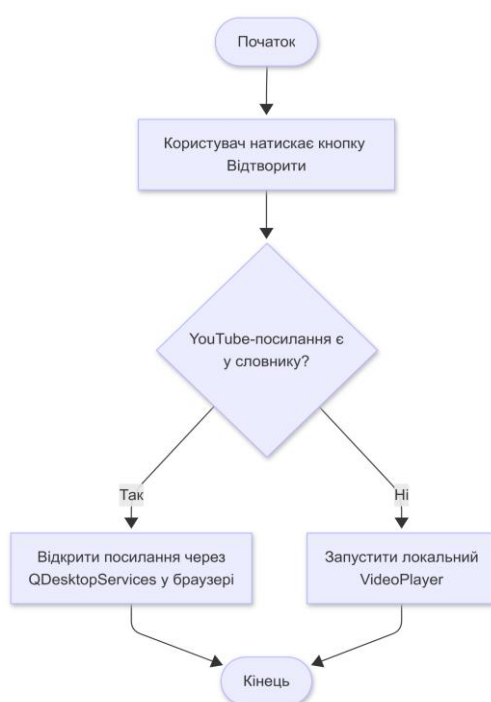
Рис. 3.16 Блок-схема алгоритму відтворення трейлера onPlay()
