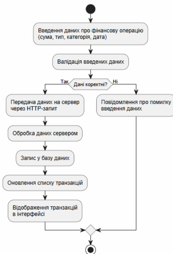
Рис. 2.5 UML-діаграма діяльності алгоритму обробки фінансових операцій у веб-додатку
