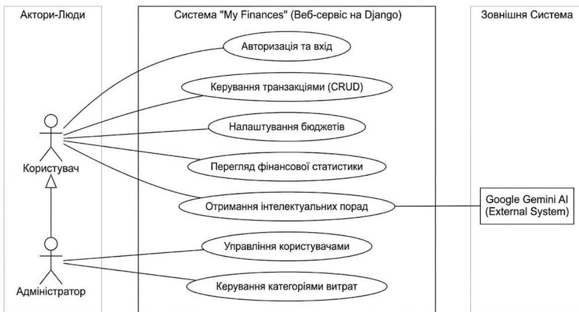
Рис. 2.2 UML-діаграма варіантів використання веб-додатку
