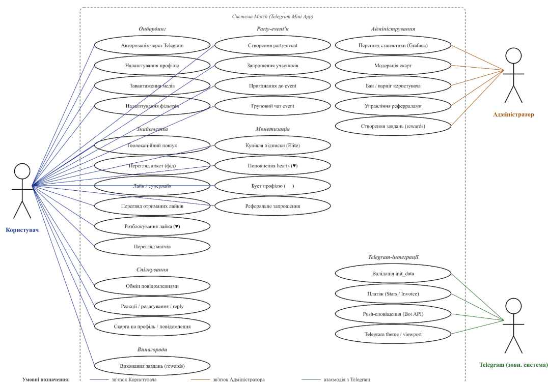
Рис. 1.2 Діаграма варіантів використання системи (актори: Користувач, Адміністратор, Telegram)
