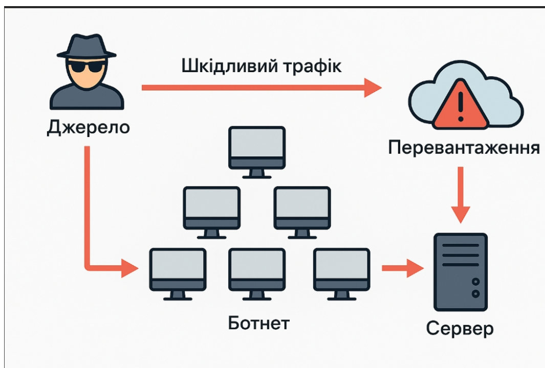
Рис. 1.1 – Схема DDoS-атаки з використанням ботнету [1]
