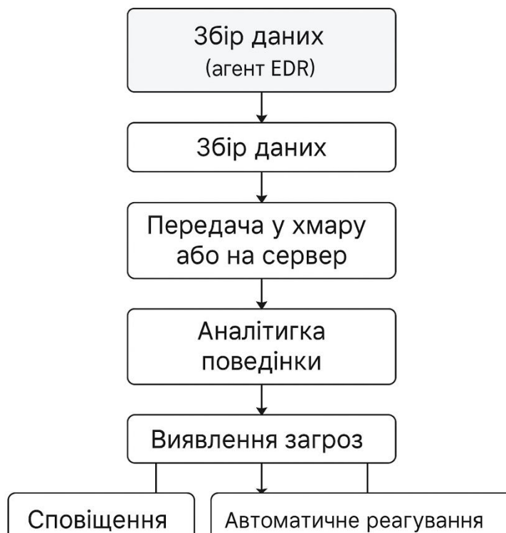
Рис. 1.1. Типова схема роботи EDR-системи
