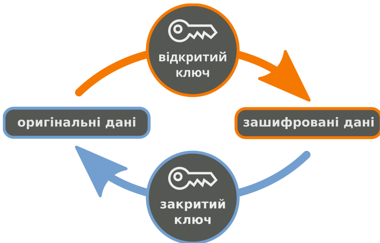
Рис. 2.6. Основний принцип асиметричної криптографії
