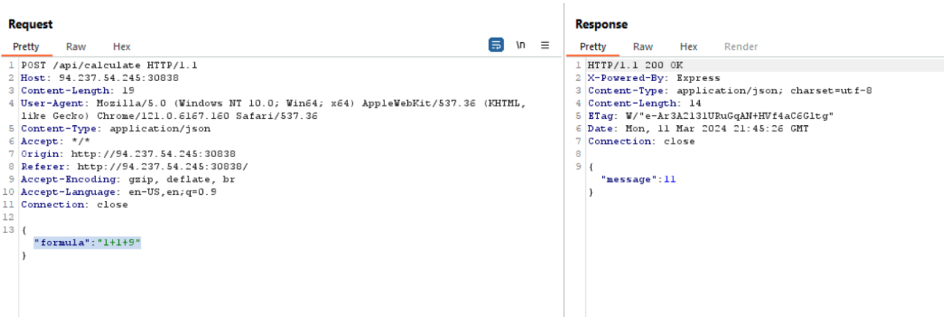
Рис. 3.16. Перехоплений POST запит за допомогою Burp Suite
