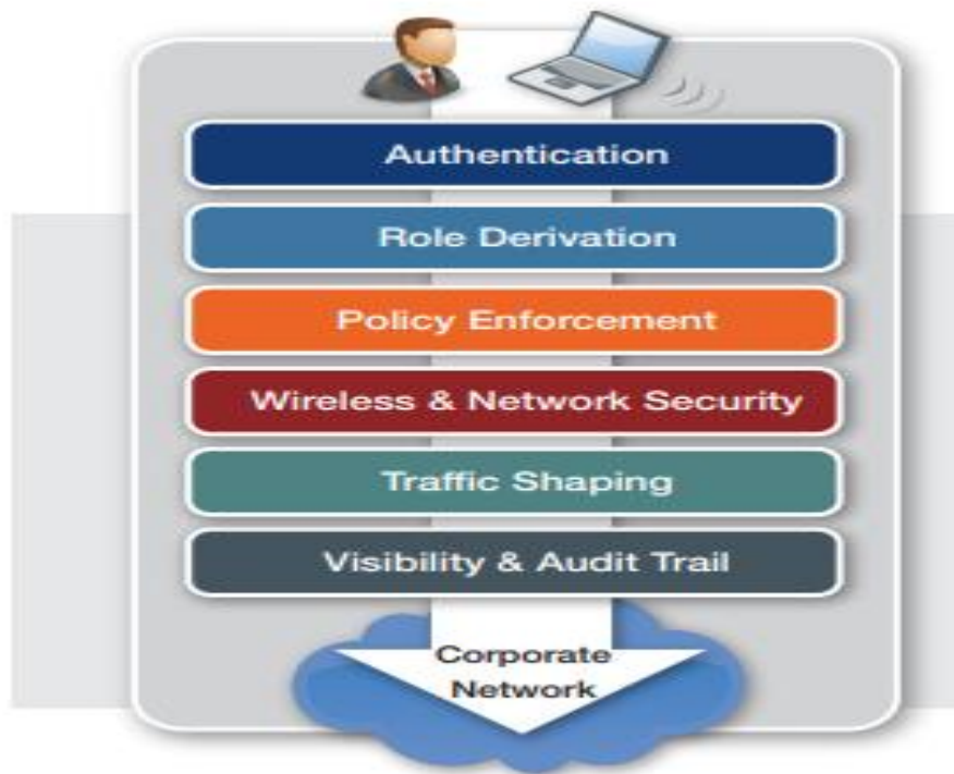
Рис. 2.2. Повна архітектура Secure Wireless LAN
