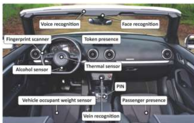
Рис.2.1. Нинішні та нові датчики MFA для транспортних засобів.
