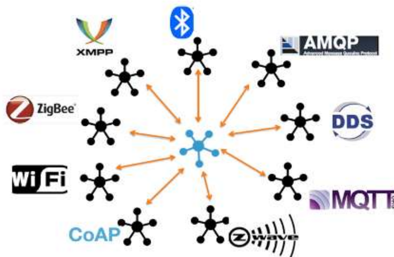
Рис 1.6 Протоколи які використовуються у IoT
