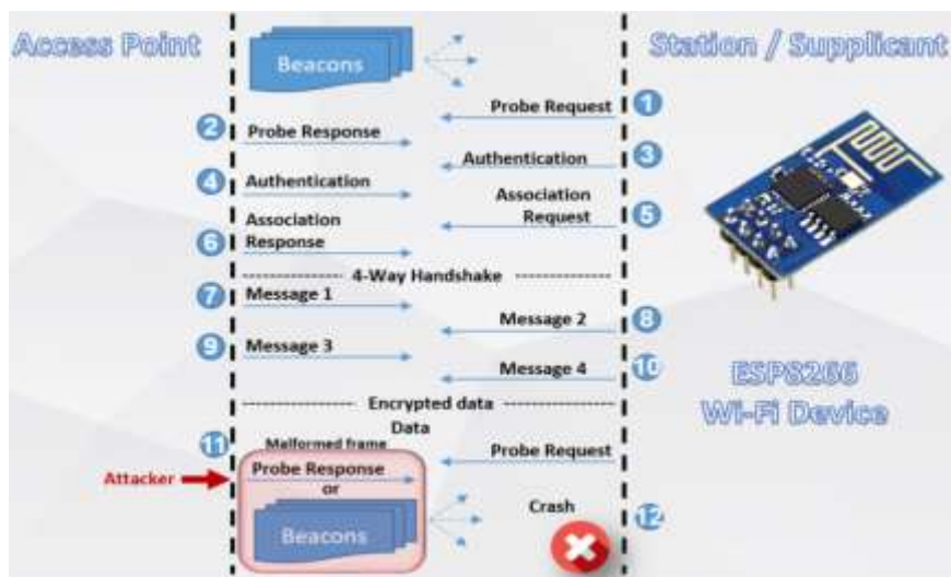
Рис. 2.7. Схема поведінки атаки, яка може привести до збою ESP8266
