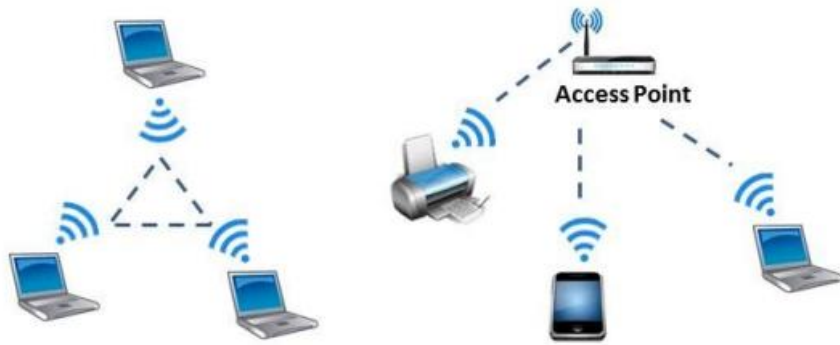
Рис.1.8. Незалежні та інфраструктурні базові набори послуг (BSS)
