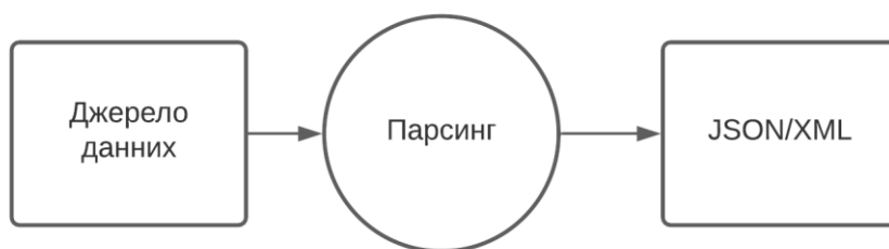
Рисунок 1.5 Схема роботи парсера
