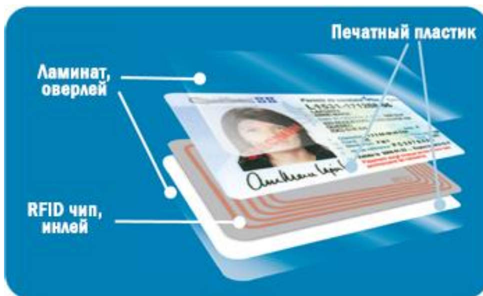
Рис.1.22.Вигляд перепустки з використанням RFID-технології
