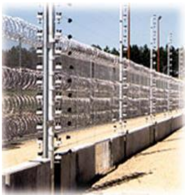
Рис. 1.6. Варіант розміщення радіопроменевої системи виявлення порушників «ЕМЦ 200, 300, 500»
