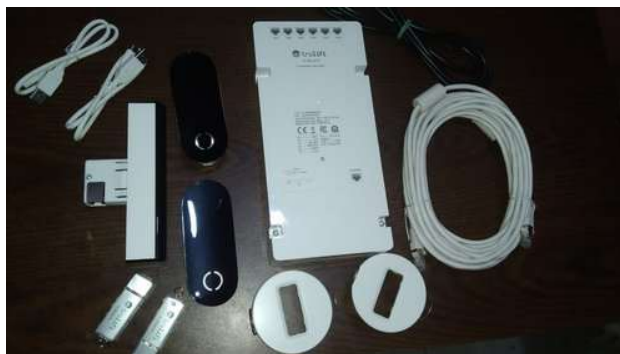
Рисунок 3.14 – Набір для реалізації Li-Fi Trulifi 6002.1 Starter Kit System
