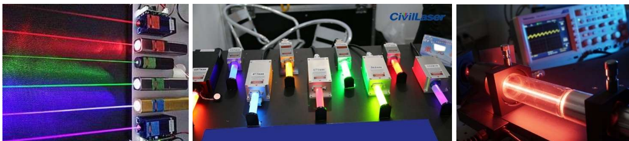
Рисунок 2.1 – Типи лазерів: напівпровідникові, твердотільні, газові
