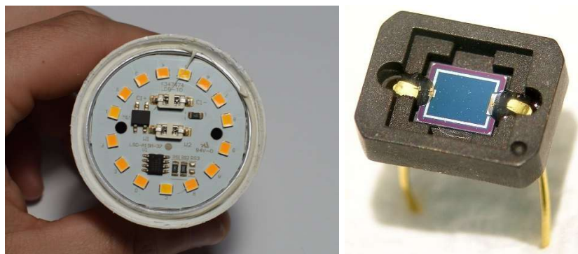
Рисунок 3.1 – LED модуль (для передачі даних) та фотодіод (для прийому даних)
