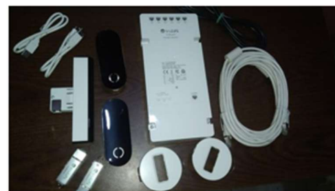
Рис. 3.14 – Набір для реалізації Li-Fi Trulifi 6002.1 Starter Kit System
