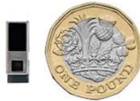
Рис. 3.11 – Існуюча серійна Li-Fi антена від pureLi-Fi
