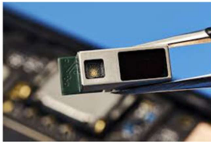
Рис. 3.11 – Існуюча серійна Li-Fi антена від pureLi-Fi
