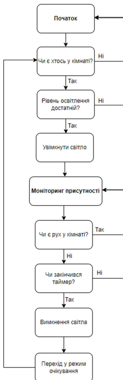
Рисунок 3.3 – Приклад роботи сценарію «Керування освітленням на основі датчиків руху або рівня освітлення»
