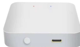
Рис. 2.21 – Шлюз TuYa Smart Multi-mode Zigbee 3.0, що поєднує протоколи Zigbee та Bluetooth
