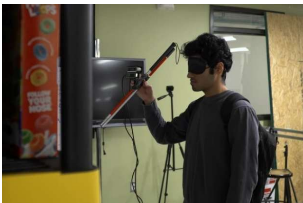
Рисунок 3.1 – Прототип розумної тростини з інтеграцією комп'ютерного зору та штучного інтелекту
