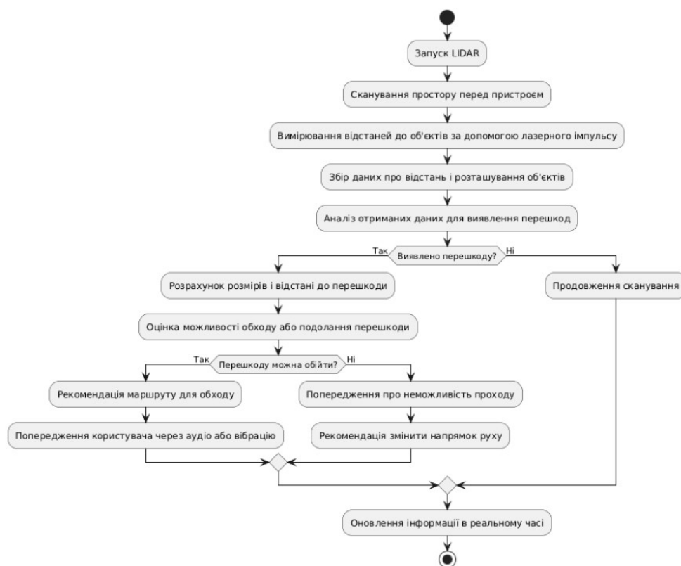
Рисунок 3.10 – Схема роботи LiDAR у роботі пристрою орієнтації
