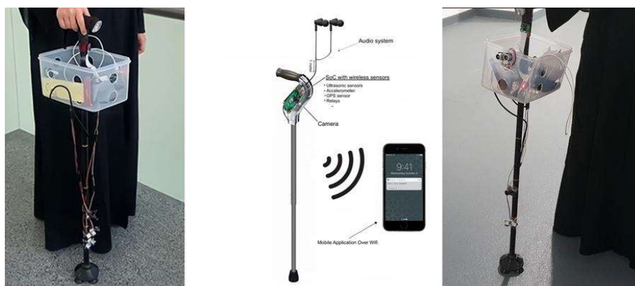
Рисунок 1.21 – Розроблений прототип носимого пристрою: розумна тростина
