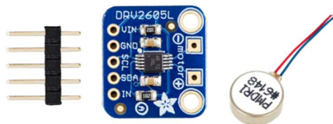
Рисунок 3.20 – Вібраційний контролер Adafruit DRV2605L Haptic Motor Controller та мотор Precision Microdrives 10mm LRA (C10-100)
