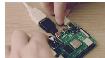
Рисунок 12 – Підключення до джерела живлення
