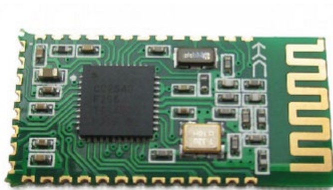
Рисунок 2.3 – Bluetooth модуль HC-08
