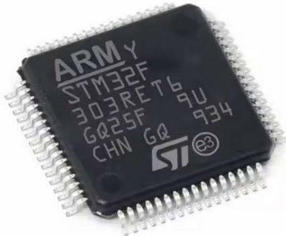
Рис. 2.1 – Мікроконтролер STM32F303RE в корпусі LQFP64
