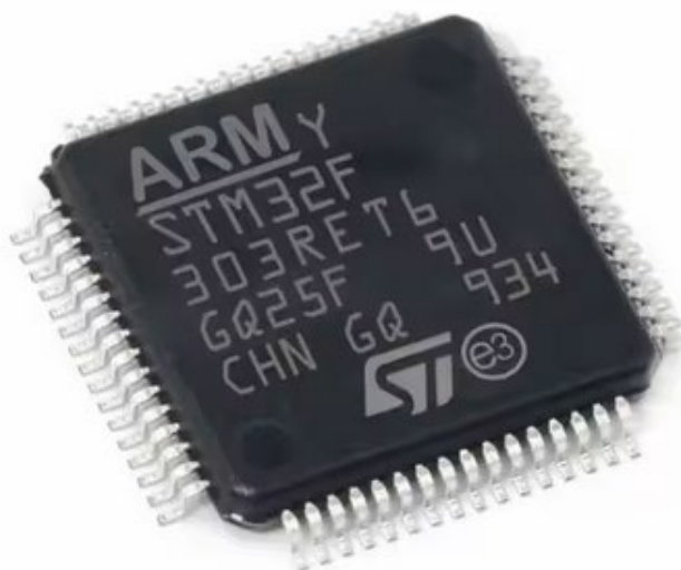
Рисунок 2.1 – Мікроконтролер STM32F303RE в корпусі LQFP64
