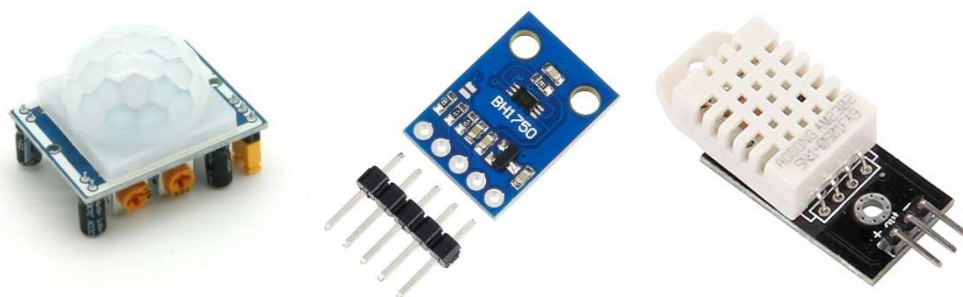
Рисунок 3.11 – Датчик руху (HC-SR501), освітленості (BH1750) та рівня температури та вологості (датчик DHT22)
