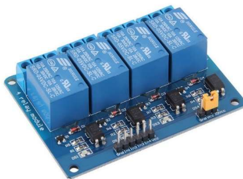
Рисунок 3.9 – Реле для комутації джерел живлення 4-Channel Relay
