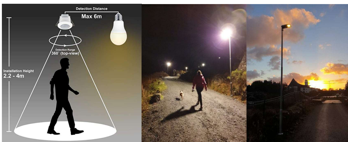
Рисунок 1.9 – Використання датчиків освітленості та руху для зниження енерговитрат у часи простою
