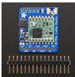
Рисунок 3.8 – Модуль безпроводного зв'язку RFM95W LoRa 915MHz Module
