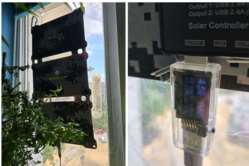
Рисунок 3.1 – Робота сонячної EFTE-панелі в умовах затінку
