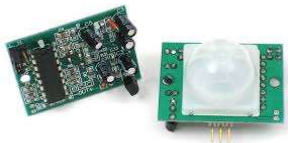
Рисунок 2.1 – Датчики руху, або PIR-сенсори (пасивні інфрачервоні сенсори)
