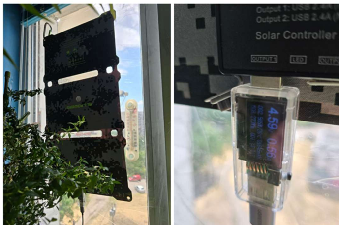
Рис. 3.1 – Робота сонячної EFTE-панелі в умовах затінку
