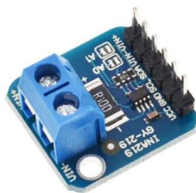
Рисунок 3.10 – Датчик для моніторингу напруги та струму INA219
