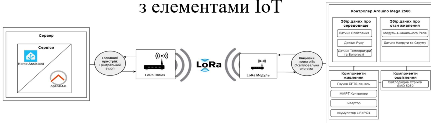
Рис. 2.20 – Схема передачі та прийому даних у двох напрямках (освітлювальна система та центральний шлюз)
