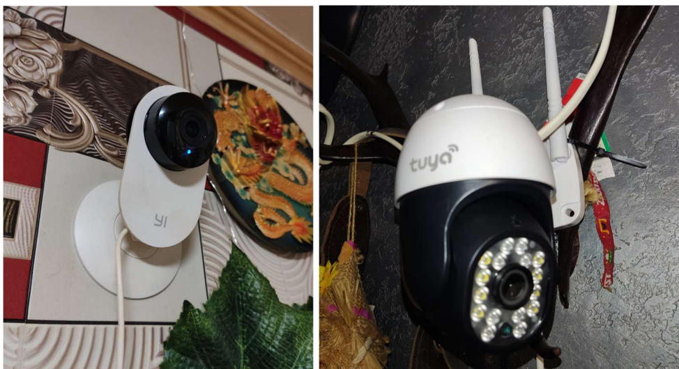
Рисунок 1.13 – Повністю автономні системи відеоспостереження в межах одного пристрою (зліва направо: Xiaomi Yi Home 720p та Tuuya C18)
