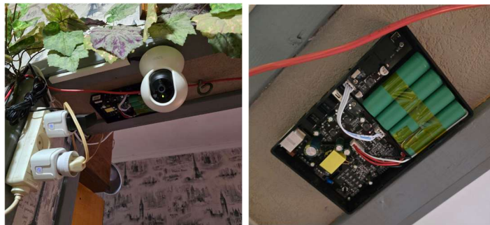
Рисунок 4.3 – Забезпечення автономності інтелектуальній камері відеоспостереження у якості ДБЖ (максимальне споживання 5.4 Вт, ~20 годин автономності зі ДБЖ)
