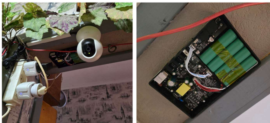
Рис. 4.3 – Забезпечення автономності інтелектуальній камері відеоспостереження у якості ДБЖ (максимальне споживання 5.4 Вт, ~20 годин автономності зі ДБЖ)
