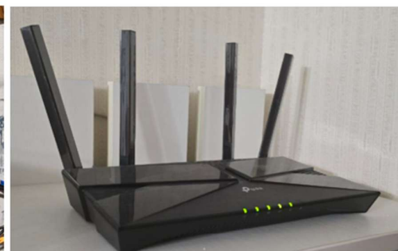
Рис. 3.17 – Маршрутизатори TP-Link Archer AX73 та AX53 (з'єднані у EasyMesh – провідним бекхолом)
