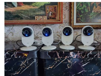
Рис. 1.5 – Камери відеоспостереження Xiaomi Yi Home 720p з автономним живленням від портативних зарядних пристроїв
