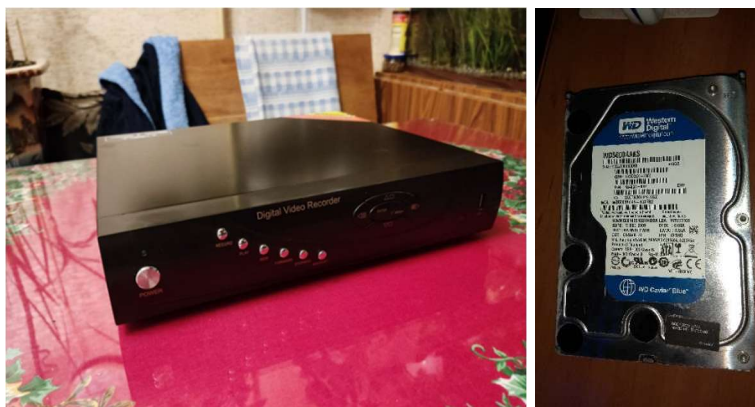
Рисунок 1.2 – Полусправний відеореєстратор «TVT TD-2308SE-SL» та демонтований жорсткий диск «Western Digital Blue 500GB»
