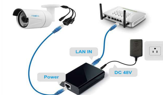
Рисунок 1.4 – Використання патч-корду у якості живлення на камерах відеоспостереження від виробника Reolink
