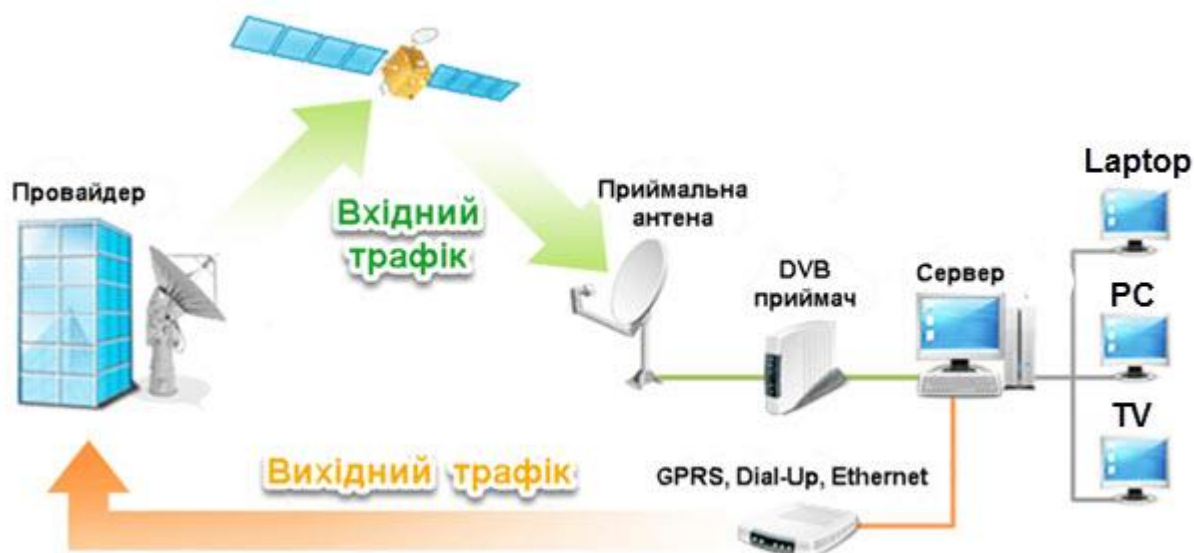
Рисунок 1.1 – Прикладна схема супутникового інтернету
