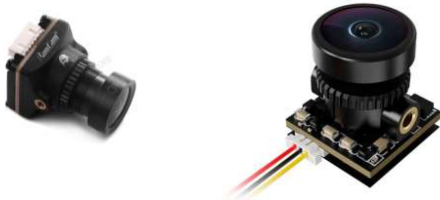
Рис. 3.7 Приклади камер для first person view дронів
