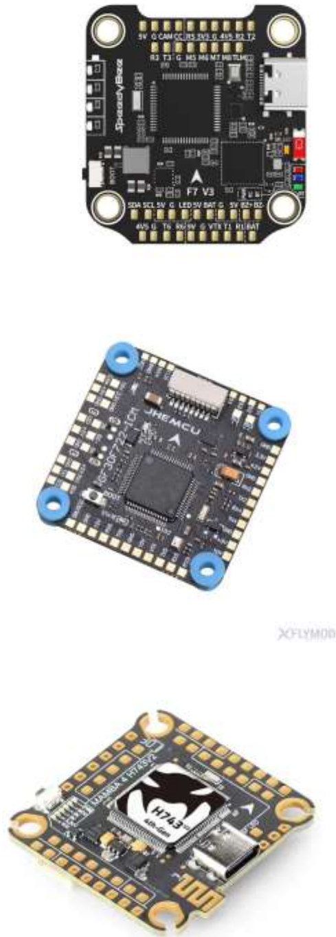
Рис. 3.2 Приклади політного контролера для first person view дронів
