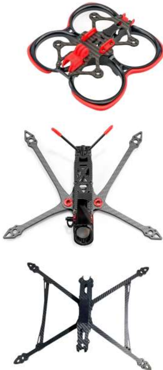
Рис. 3.1 Приклади рам для first person view безпілотних літальних апаратів
