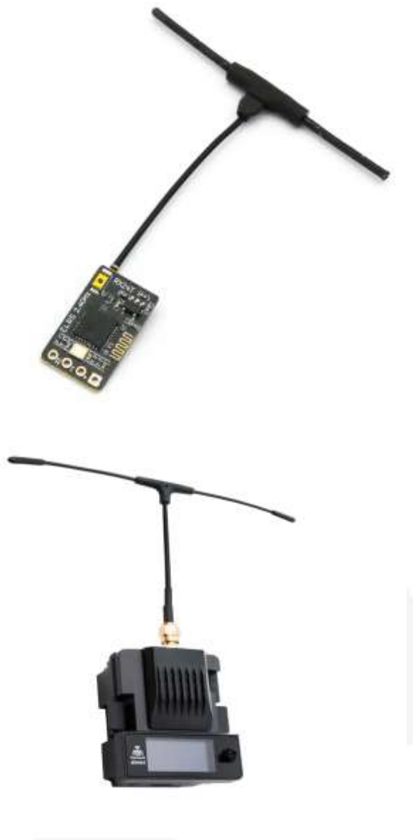
Рис. 3.5 Приклади RX та TX для first person view дронів
