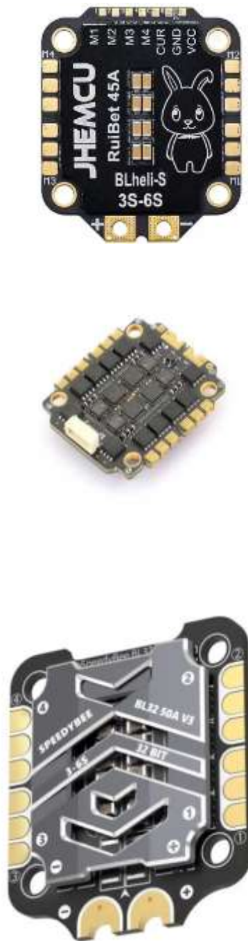
Рис. 3.3 Приклади регулятора обортів для first person view дронів
