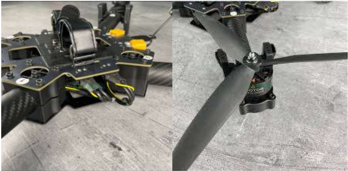
Рис. 4.5 Двигуни та елементи БПЛА на основі корпусу Diatone KN-104
