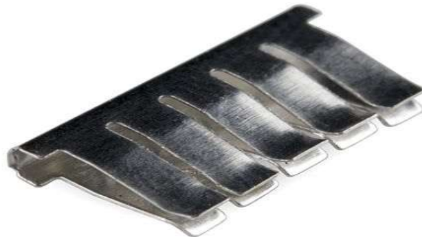
Рисунок 17 – Кліпси, які розташовані в макетній платі
