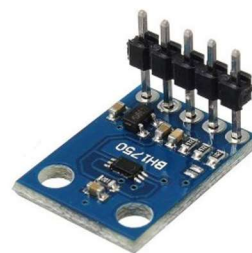
Датчик освітленості (BH1750)
