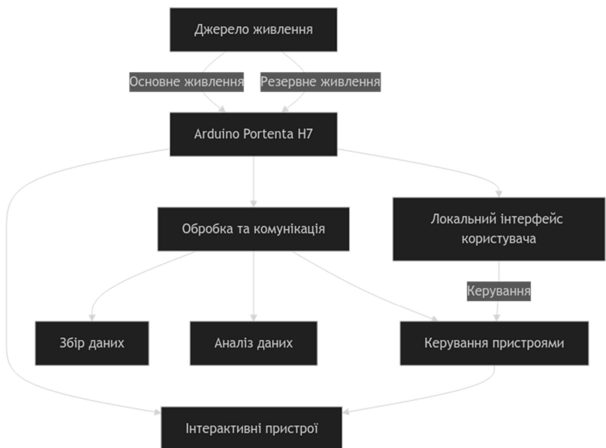
Рисунок 3.1 – Блок схема розумного будинку
