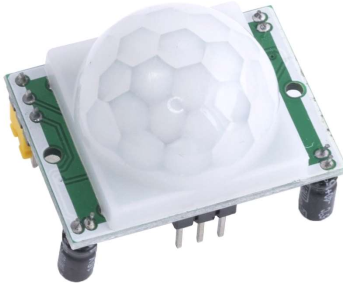
Рисунок 3.3 – Датчик руху PIR (HC-SR501)
