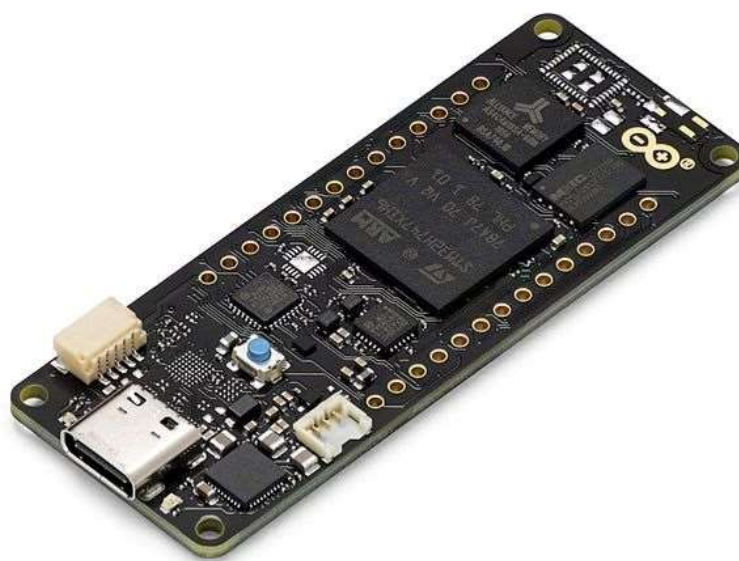
Рисунок 3.2 – Arduino Portenta H7
