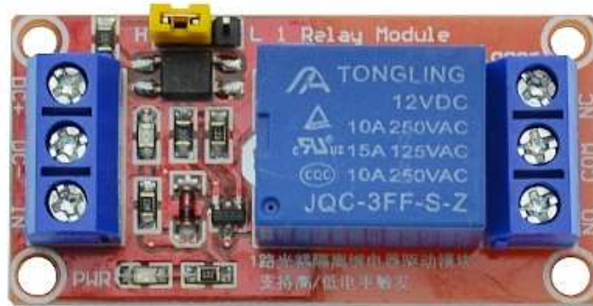
Рисунок 3.9 – Реле 1 канал 12 В
