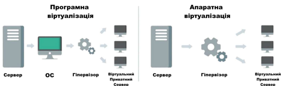
Рисунок 1.9 – Порівняння програмної та апаратної типів архітектури віртуалізації
