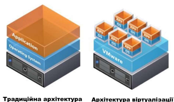
Рисунок 1.8 – Порівняння на програмному рівні існуючих архітектур
