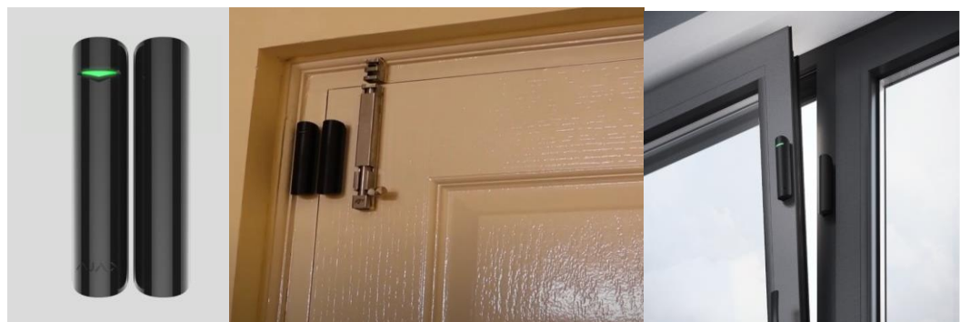
Рисунок 2.19 – Датчики з герконом та його вмонтування
