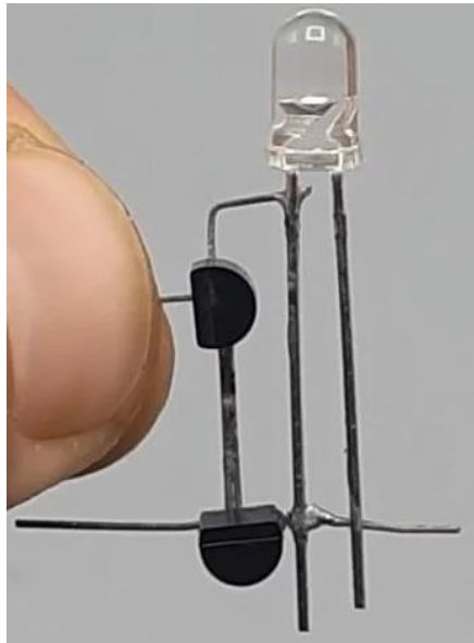
Рисунок 2.4 – ІЧ діод спаяний з колекторного з'єднання обох транзисторів.
