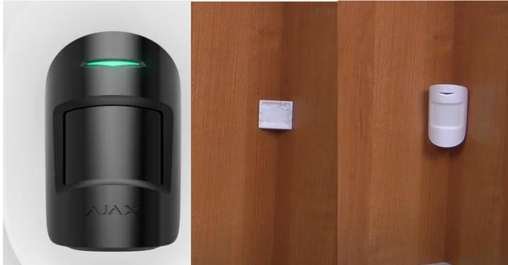
Рисунок 2.17 – Інфрачервоний Датчик та його вмонтовування
