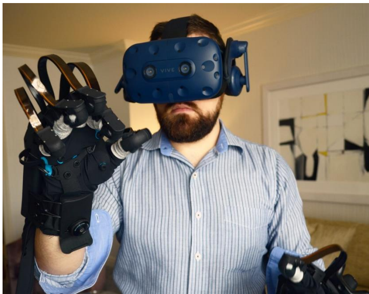
Рисунок 3.1 – Набір для взаємодії з тренажером (VR гарнітура та рукавички)
