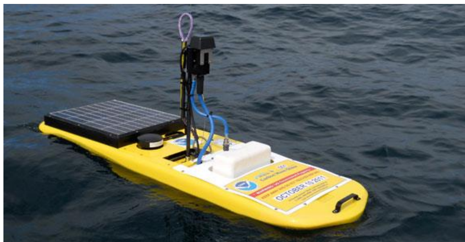
Рисунок 1.19 – Wave Glider SV3, це перший у світі гібридний безпілотний океанський робот, що працює на сонячній енергії
