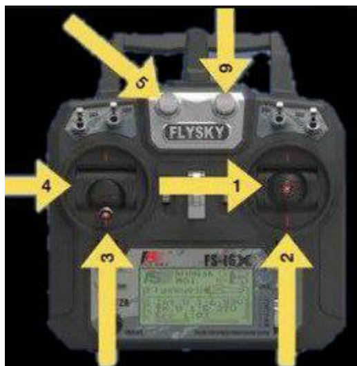
Рисунок 2.2 – знаходження каналів на контролері
