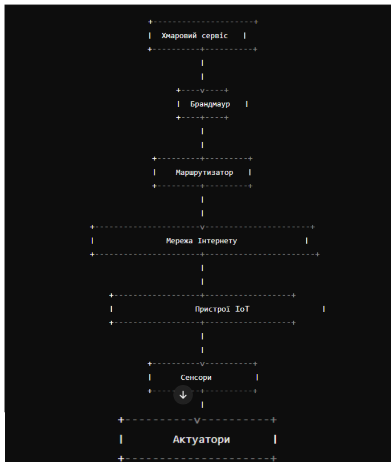
Рис. 3.2 Схема захищеної мережі IoT
