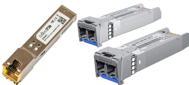
Рисунок 2.19 – Оптичний(справа) та мідний(зліва) модулі SFP
