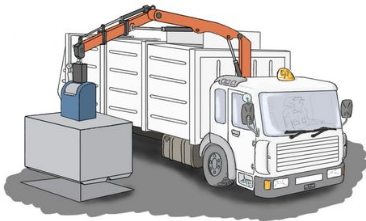
Рисунок 3.6 - Сміттєвий бак підземного типу під час збору сміття.
