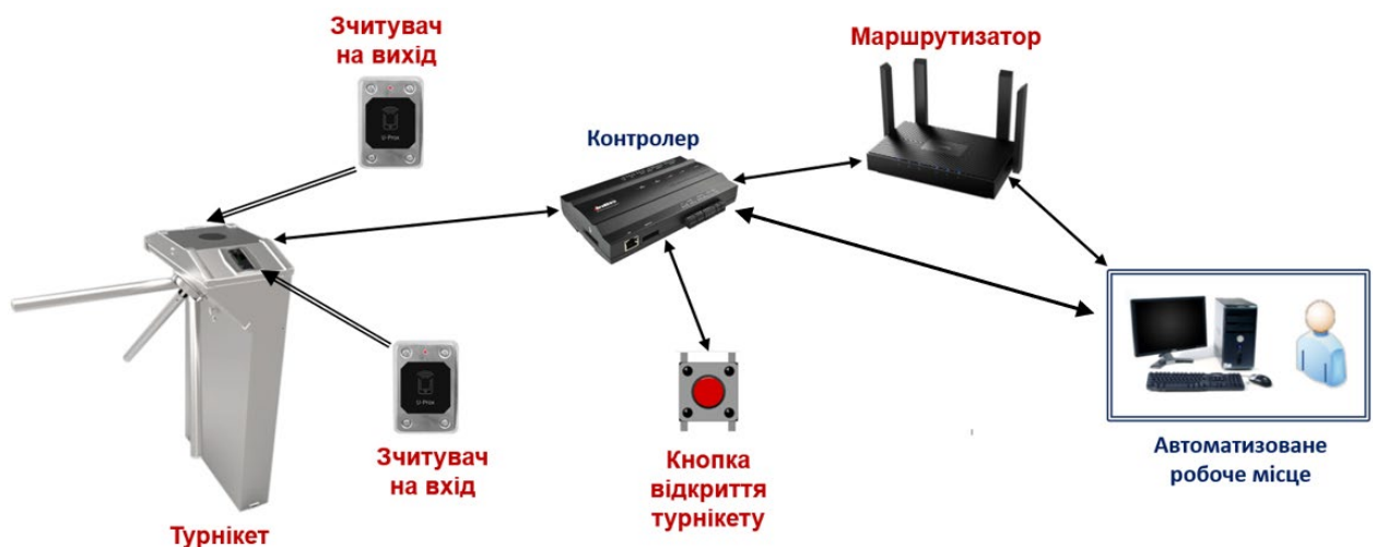
Рисунок 1.25 – Схема роботи СКД
