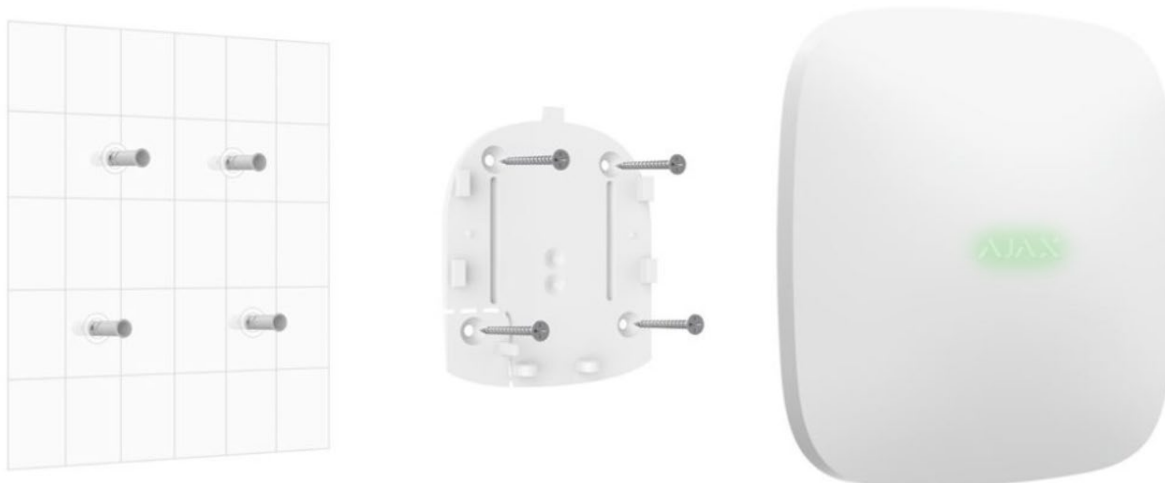
Рисунок 1.3 – Схема монтажу ППК Ajax Hub Plus
