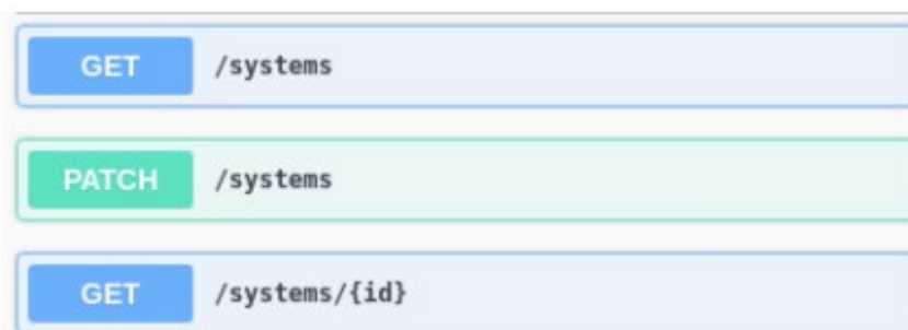
Рисунок 4.3 - Приклад структури кінцевих точок (endpoints) REST API
