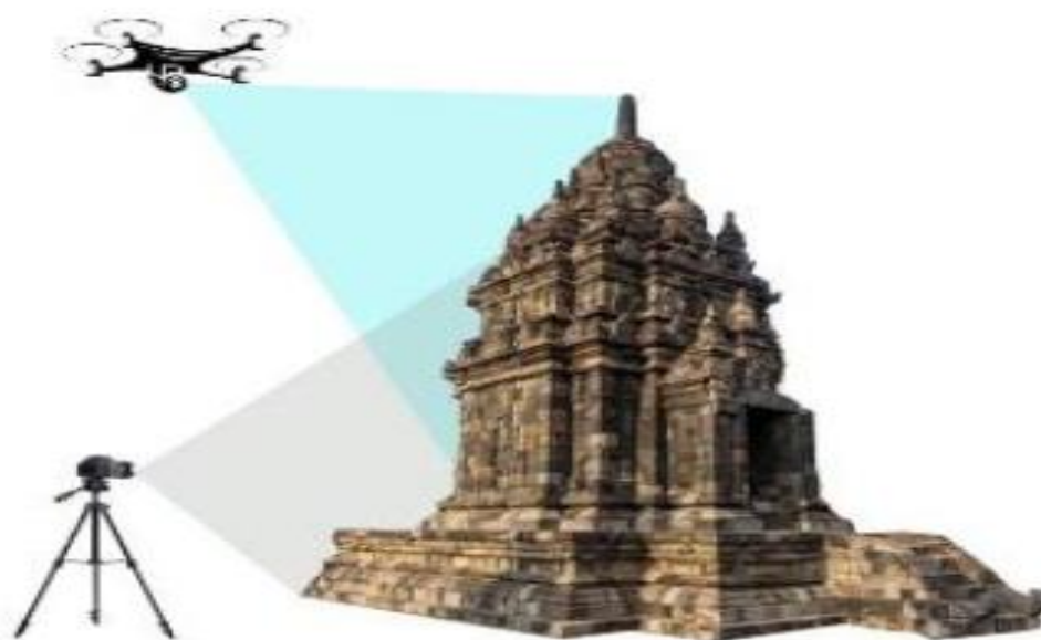
Рисунок 3.2 – Перекриття блокових зображень з DSLR-камери та дрона
