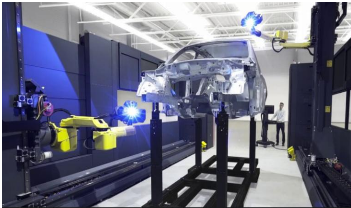
Рисунок 3.8 – ATOS Plus ScanBox, автоматична фотограмметрична система
