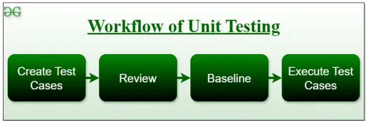
Рисунок 2.2 – Робочий процес модульного тестування [26]
